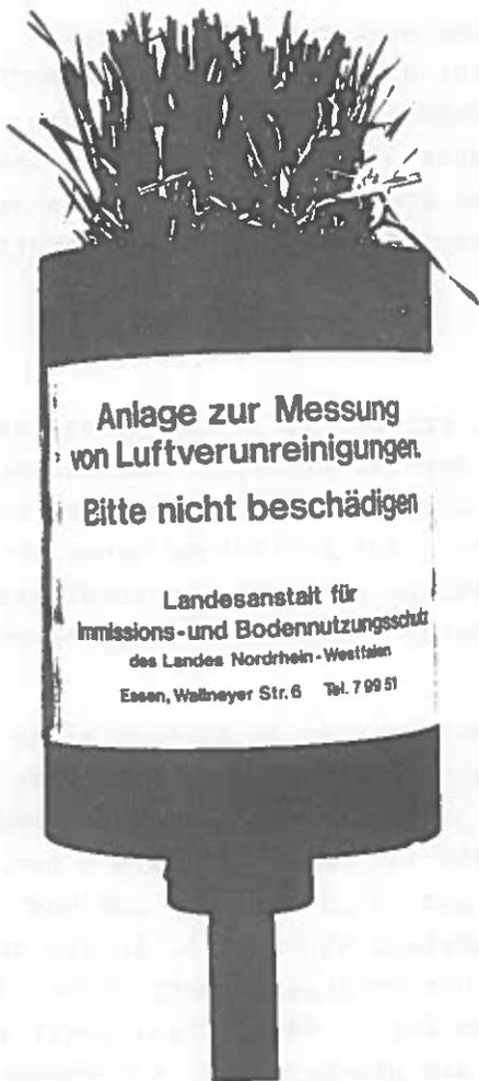
Abb. 3: Expositionsgefäß, System SCHOLL-RUDOLPH, für eine Wechselkultur. Dieses speziell für die Exposition von höheren Pflanzen entwickelte Gefäß ist als Serienprodukt auf dem Markt erhältlich.
